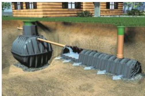
Przydomowa oczyszczalnia (fot WFOŚiGW)
